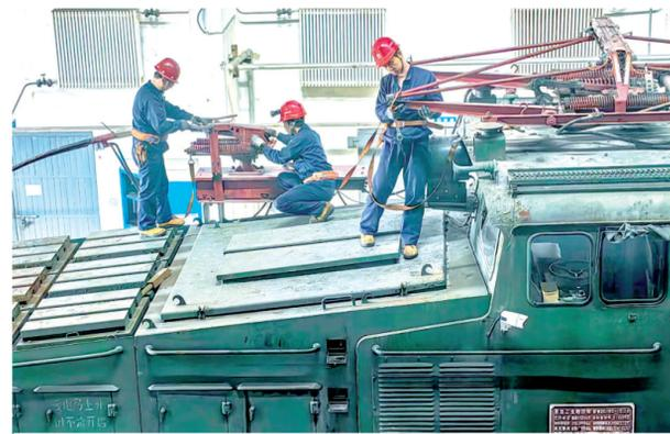
鞍钢矿业弓长岭联运公司检修作业区机车修理工正在维修167号电力机车集电器。今年以来,该公司不断加强机车维修质量管理,建立预防性维修体系,编制电力机车设备预防性维修方案,制定电力机车预防性维修标准,全力降低设备故障,提升铁路运输效率。上半年,该公司电力机车故障率同比下降23.6%。特聘记者 都基洋 摄
