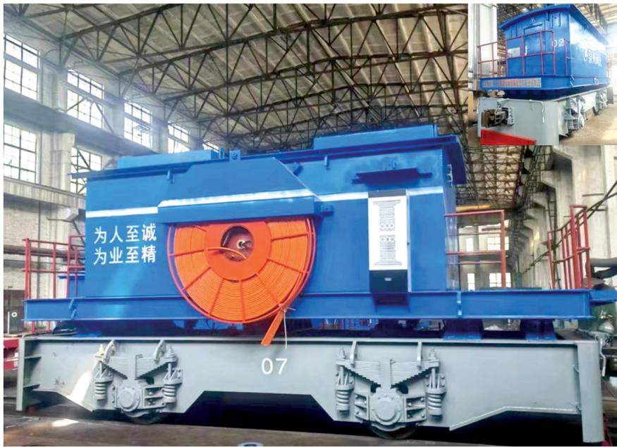
近日,鞍钢工程发展铁路设备公司为福建省某用户制造的7台高炉炉下智能牵引车如期交付。高炉炉下智能牵引车首次采用该公司自主研发设计制造的远程控制系统。该系统由PCL工控主机、工业交换机、工作台、无线网桥等部分组成,变单一控制为多重控制,可有效降低安全风险,提高工作效率。
